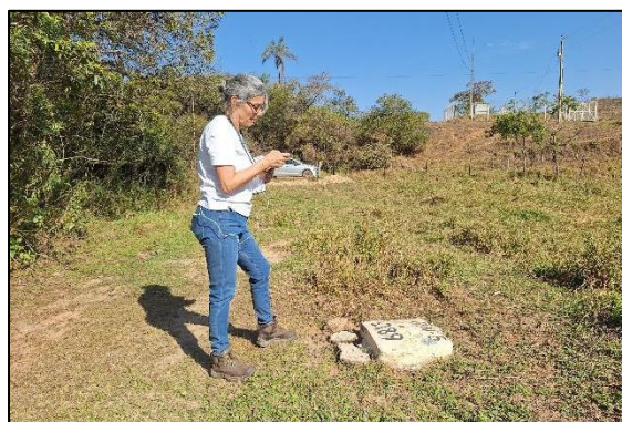
Referência de Nível (RRNN) da estação PCH Rio de Pedras - Montante. Autoria: Luísa Mosqueira Data: 14/08/2024
