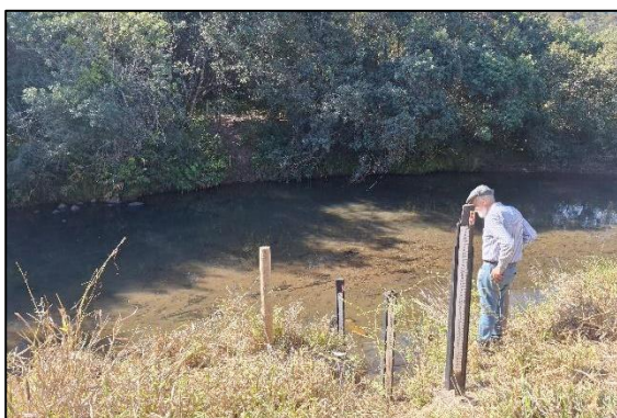
Avaliação das réguas linimétricas da estação PCH Rio de Pedras - Montante. Autoria: Luísa Mosqueira Data: 14/08/2024
